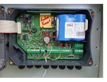
Modulo ricevitore impulsi e trasmettitore dati WATERMIND
