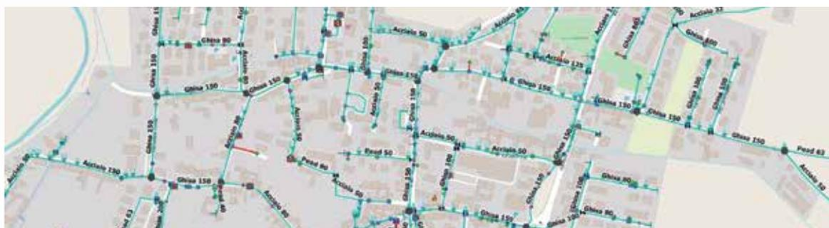
Nell'immagine sovrastante viene rappresentata la visualizzazione in formato GIS (Geographical Information System) del rilievo effettuato in campo, dove ogni punto e ogni linea presenta le medesime caratteristiche dello stato dei luoghi della rete acquedottistica.
