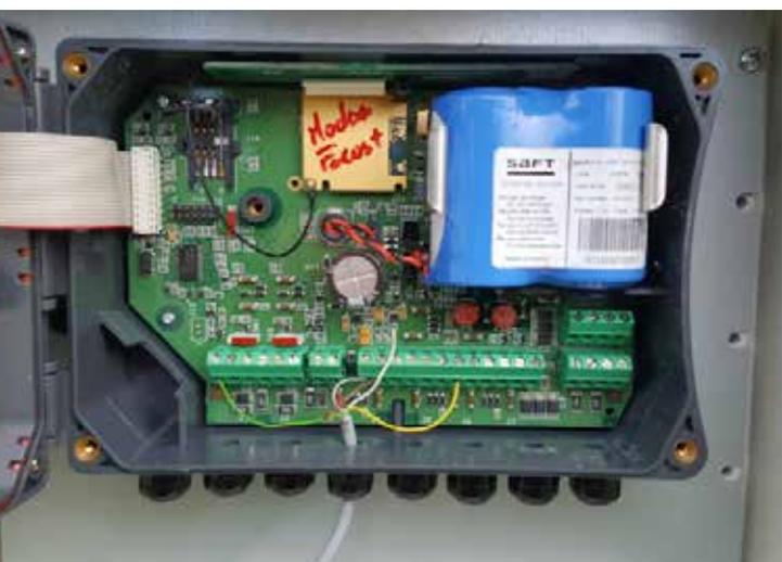
*Modulo ricevitore impulsi e trasmettitore dati WATERMIND*
